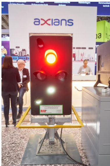
BU: Ein Showcase demonstriert die fließende Anbindung klassischer Bahnsignale an eine digitale Infrastruktur (Quelle: Axians)
